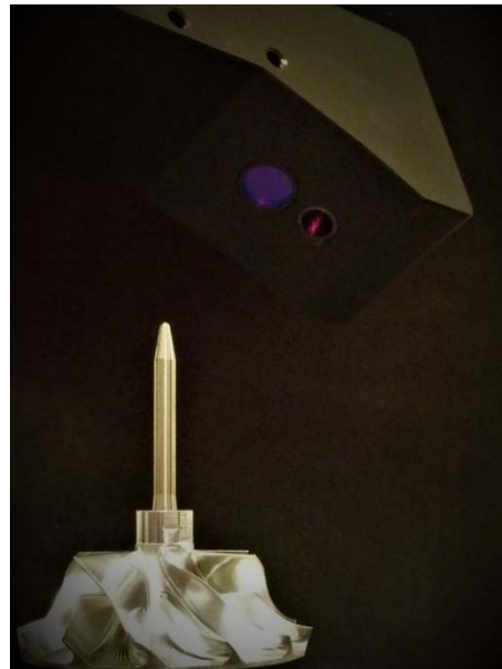
Valutazione in gran parte indipendente dalla superficie con il rilevatore di bordi RED-110-P
